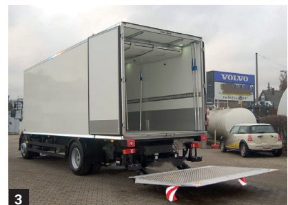
3 Hebebühne-Ablad Déchargement par ridelle hydraulique
