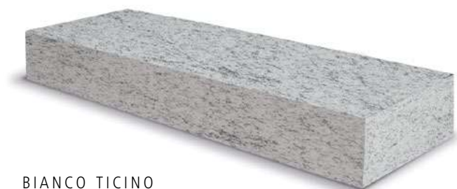
BIANCO TICINO grau blau | gris-bleu | grigio-blu Oberfläche kugelgestrahlt, alle Kanten gesägt, Vorderkante gefast Surface grenaillée, tous les bords sciés, face supérieure chanfreinée Superficie granigliata, tutte le coste segate, costa superiore bisellata Art.-Nr.
