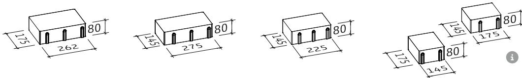
**i** Das vierte Steinformat gibt es in zwei unterschiedlichen Ausformungen: einmal für Längs- und einmal für Querverlegung.
