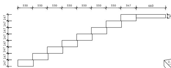
Bitte beachten: Das Radienblockstufensystem mit Standardradien funktioniert ausschließlich mit einer Überlappung der Stufen um 1,7 cm. Die Verlegung ist nur ohne Gefälle möglich.
