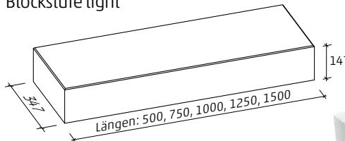
**i** Durch Aussparungen auf der Unterseite sitzt die Stufe sicher im Fundament, ist aber mit 87 Kg (Meterstufe) im Vergleich zur Vollstufe mit 128 Kg einfacher zu versetzen.
