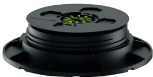
Das Stelzlager Uptec SUPAS ist von 43 bis 58 mm höhenverstellbar und hat einen Basisteller mit 190 mm Durchmesser und einen Kopf mit einem Durchmesser von 130 mm. Am Kopf können Teller für die Standardverlegung (Fugenbreite 2mm oder 4mm) oder für die Verlegung mit Aluminiumschiene bzw mit Holzbalken angebracht werden. Am Basisteil befinden sich Löcher für den Wasserablauf und auf der Unterseite sind 4 Einkerbungen für eventuelle Zuschnitte zu finden.
