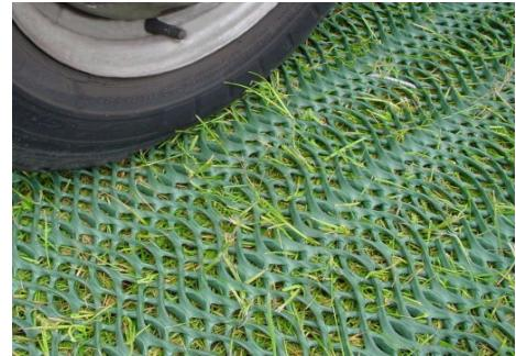
**Grasprotecta** ist ein Maschengewebe aus Polyethylen, das stark, flexibel und sich durch eine lange Haltbarkeit auszeichnet. Das Produkt kann auf festem Boden effektiv eingesetzt werden. Einfach ausrollen und die Ränder mit Metallhaken befestigen. Das Gras wächst nach kurzer Zeit durch die Maschen und erreicht eine zu mähende Höhe.
