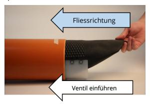
a) Vor dem Einbau den Klemmmechanismus komplett lösen und die Rückstausicherung mit Wasser benetzen. (evtl. wenig Seife)
