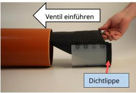
b) Die Rückstausicherung in das Rohr schieben bis die Dichtlippe ganz im Rohr aufliegt.
