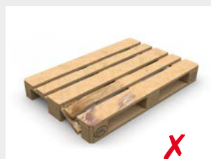
Bruch eines Querbrettes
