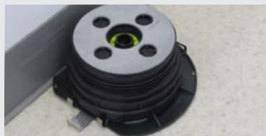
D-2. Das Stelzlager mit einer abgeschnittenen Seite zur Wand und mit der anderen Seite nach außen positionieren.
